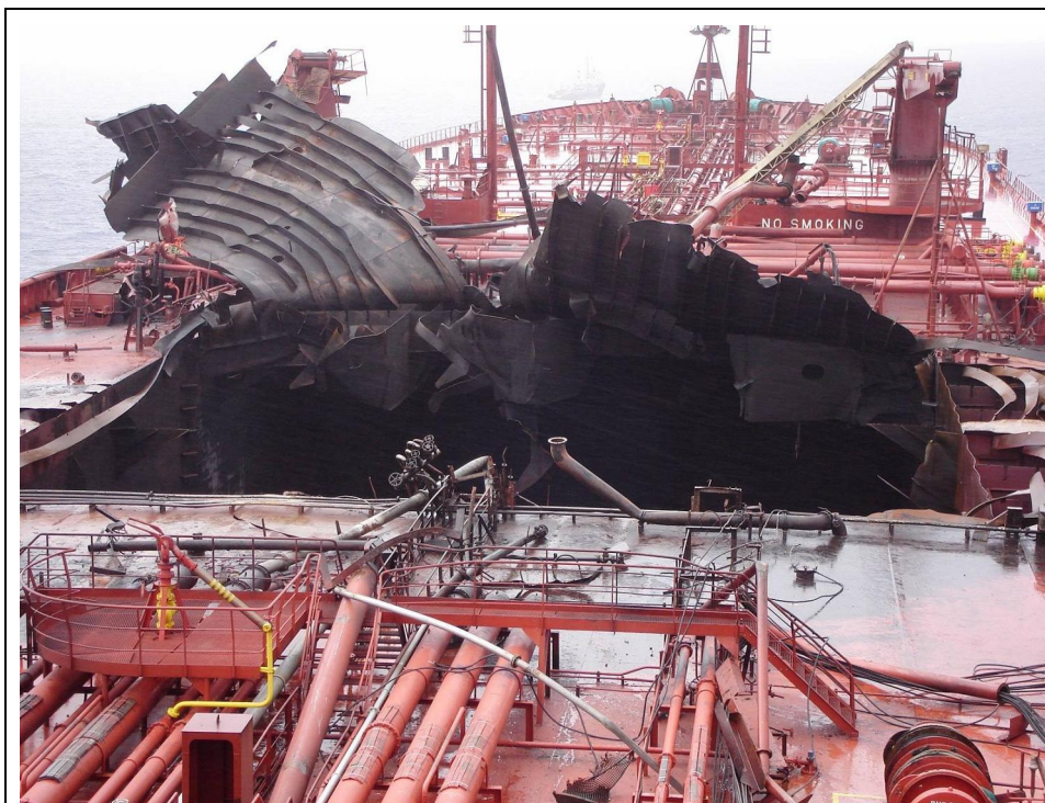
Nổ kết hàng tàu dầu do thuyền viên không tuân thủ đúng quy trình làm việc trong khu vực kín trên tàu dầu khi thực hiện hot work ở kết này
