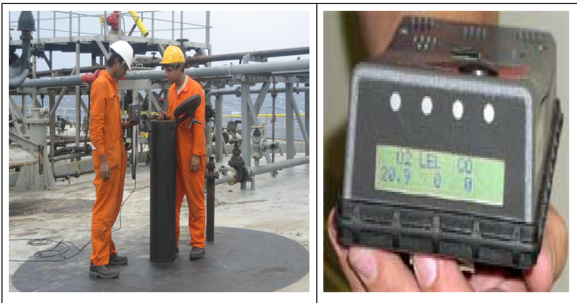
Sử dụng thiết bị đo khí trong kết/ khu vực kín trên tàu
